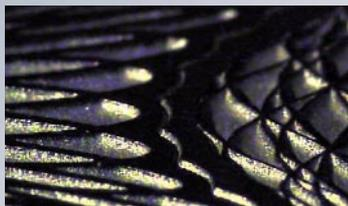
Laserabtrag im  $\mu$ -Bereich. Mikroskopaufnahme eines Druckklischees.
